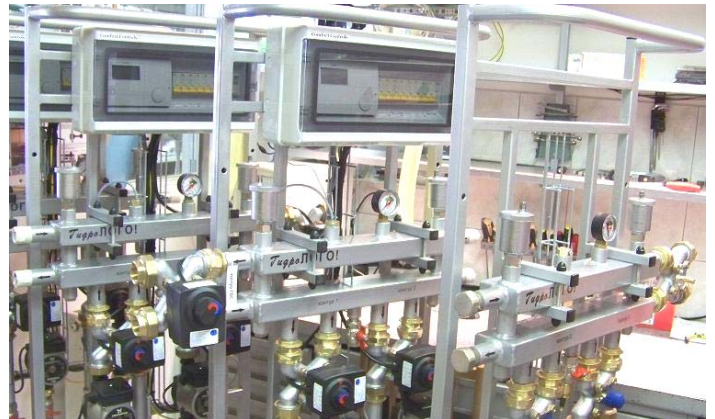
Производство управляемых гидромодулей ГидроЛОГО! с контроллерами E8 фирмы Кромшредер.
