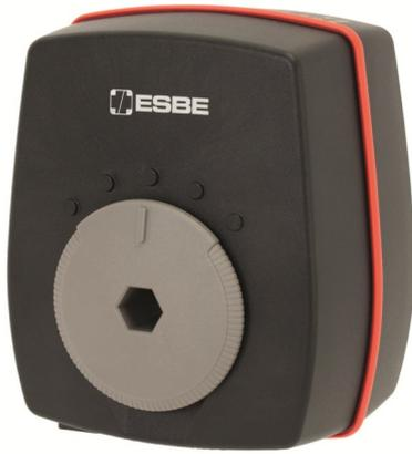
Сервопривод АРА598 с управлением сигналом **PWM** (широкоимпульсная модуляция) или пропорциональным сигналом (0-10В или 0-20мА) имеет напряжение питания =12-24В, или ~24В.
